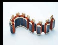
Mitsubishi Electric ha creato e sviluppato un motore elettrico DC Inverter estremamente compatto ed altamente efficiente denominato "Poki Poki". Lo statore del motore Poki Poki non è costituito da un corpo unico ma sezionato in più parti (noccioli). I singoli noccioli subiscono singolarmente il processo di avvolgimento della bobina (Joint Lap), in modo tale che il processo di avvolgimento minimizzi lo spazio morto ed aumenti l'efficienza.
